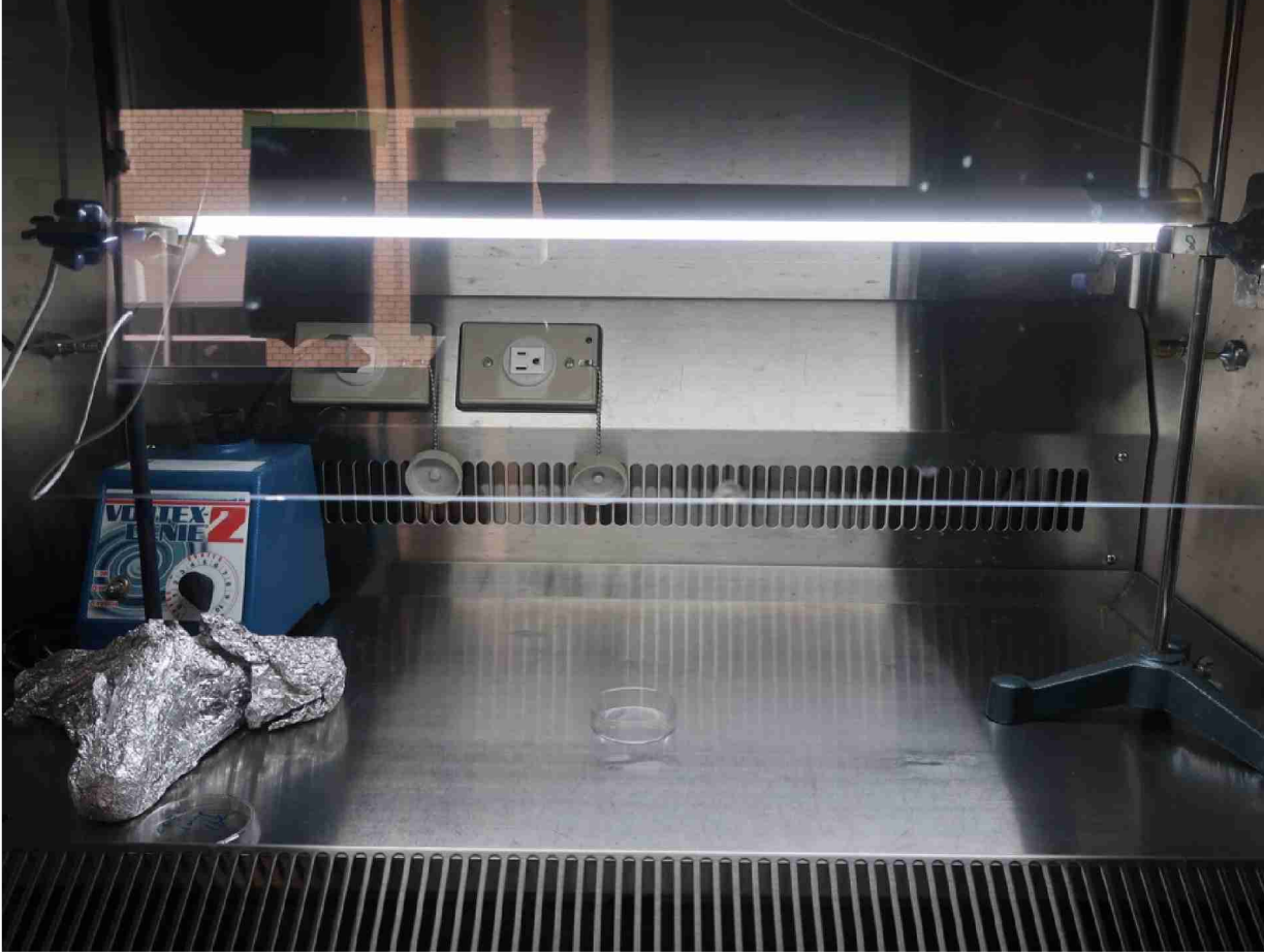
図2. アイセーブ抗菌 CCFL 電球から新型コロナウイルスを塗抹させたシャーレに照射（試験2）
