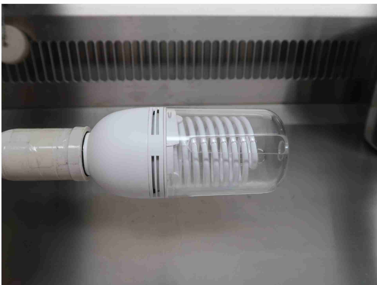
図 1. アイセーブ抗菌 CCFL 電球に新型コロナウイルスを接種 (試験 1)
